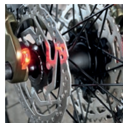
An den Achsaufnahmen links und rechts sitzen die MonkeyLink-Twin Lights.
