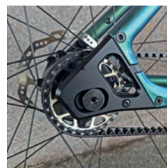
Der Stahlrahmen am Waldwiesel ist ein Gedicht. Viele Rohrverbindungen sind hier 3D-gedruckt.
