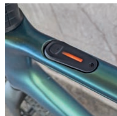
Minimalistisch und schlicht, aber vor allem im Gelände unpraktisch, weil die Hand vom Lenker muss: Einstellpanel am Oberrohr.
